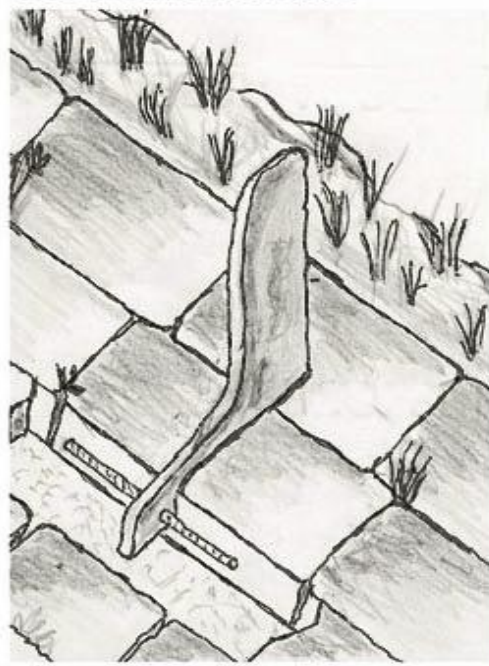
Fig. 2 Spaccato del medesimo tratto che visualizza l'ancoraggio di sicurezza del paracarro
